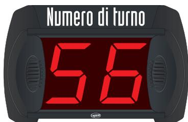
**MD2** - Display elettronico a 2 cifre a segmenti luminosi per l'indicazione del numero progressivo di turno. Realizzato in materiale plastico ed alluminio è corredato di accessori per l'aggancio a parete. E' dotato di avvisatore acustico, lampeggio delle cifre e azzeramento. Tutti i display MD2 possono essere collegati l'uno all'altro per la visualizzazione dello stesso numero progressivo.
